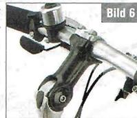
**Achtung** Am Vorbau finden Sie einen Markierungsstrich, der anzeigt, wie weit die Lenkerstütze maximal herausgezogen werden darf. Halten Sie sich unbedingt an diese Vorgabe!
